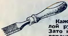
Кажется, пустяк — сделать напильником плоский спил на круглой ручке любого-нибудь инструмента: напильника или отвертки. Зато им станет удобнее пользоваться. Инструмент не будет проворачиваться в руке. Кроме того, он не скатится по столу на пол.
