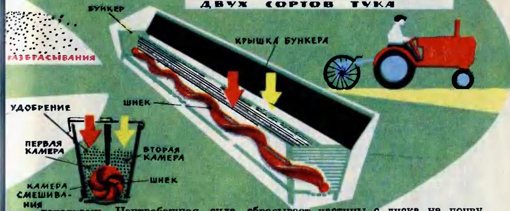
лопатками. Центробежная сила сбрасывает частицы с диска на почву (см. рис.).
